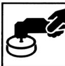
El producto, también se puede aplicar a máquina con paño circular de espuma, trabajando entre 1600 y 2000 rpm. Ejerza baja presión y mueva la máquina en forma lenta y contante para prevenir que se caliente por fricción la superficie. (En caso de ser necesario rociar la superficie con agua durante la aplicación). Retire el exceso y limpie la superficie con un paño de micro fibra suave.
